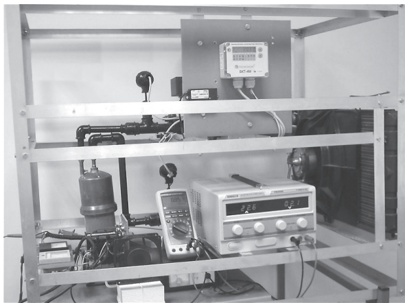
Рис. 4. Экспериментальная установка для исследования рекомбинации водорода
